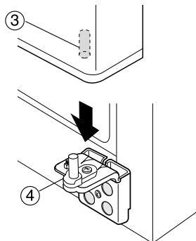
3) Вставьте стержень верхней петли (5) в отверстие (6), после того, как совместите отверстие в верхней петле (7) с отверстием в корпусе холодильника (8). Заверните винты крепления петли (9) и винт (10) по часовой стрелке.
